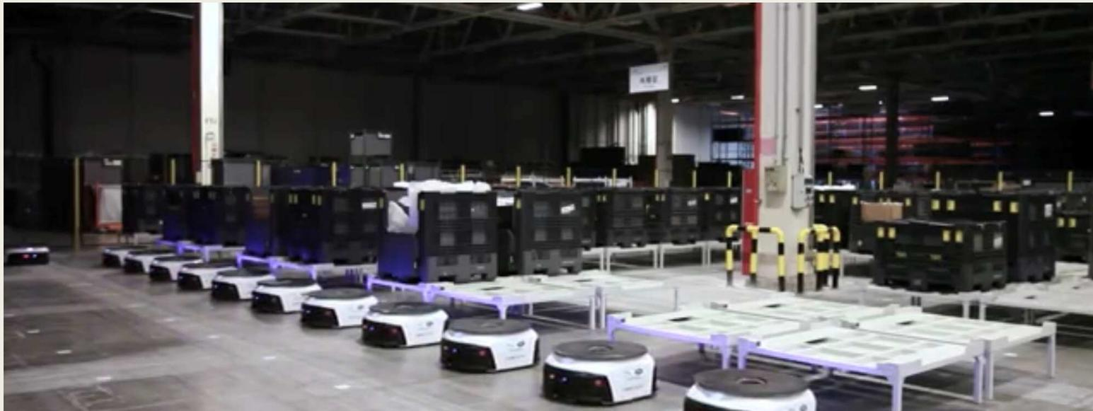
236 AGVs agieren auf insgesamt 7000 m<sup>2</sup> bei Geschwindigkeiten bis zu 1,5 m/sek.
