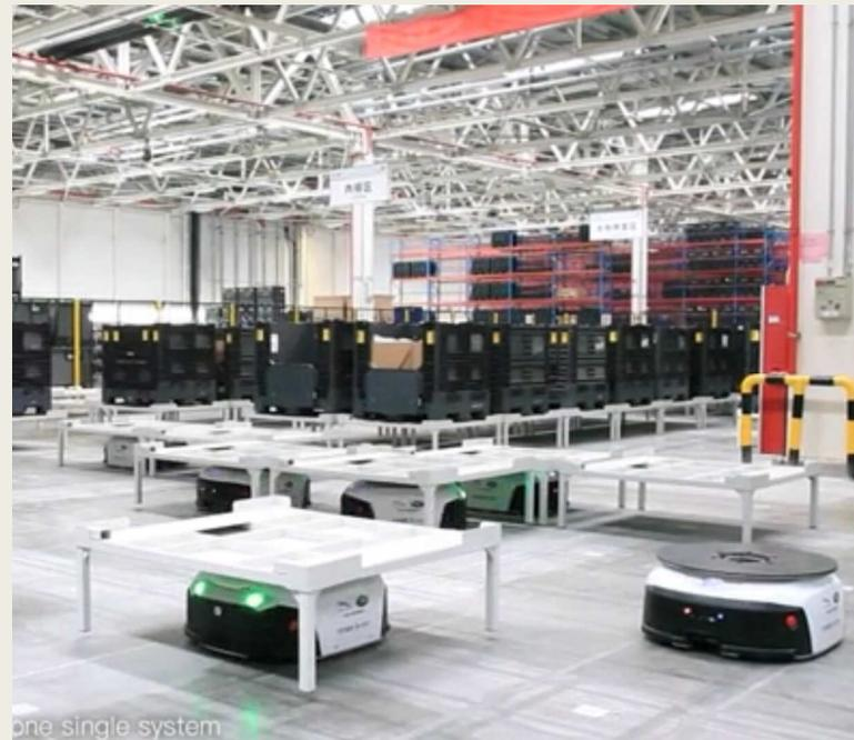
Planung von Hunderten von FTF in einem einzigen System. Echtzeitüberwachung von Bestellungen und Fahrzeugen mit Remote-Support-Funktion
